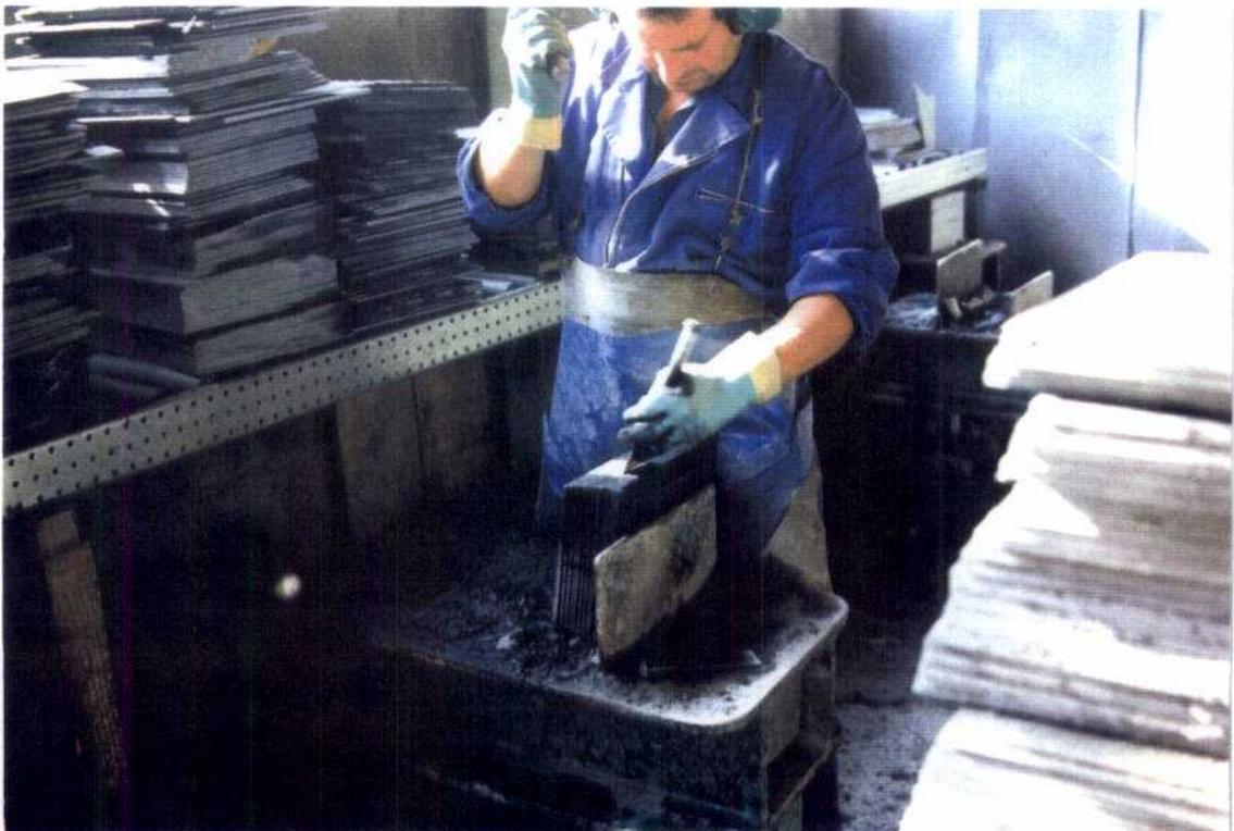
**Fotografía N° 12.- Labrado del bloque de pizarra procedente de la sierra**
