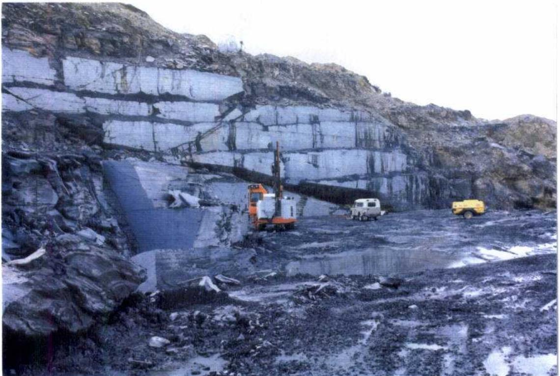
**Fotografía N° 2.- Arranque del rachón mediante explosivos**
