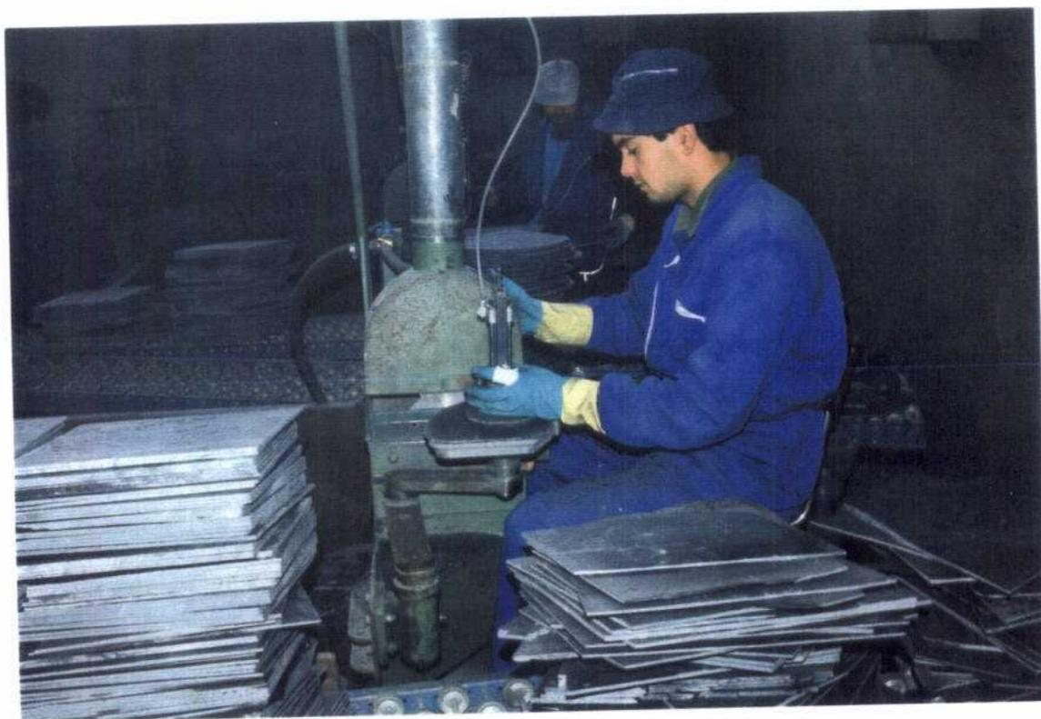
**Fotografía N° 14.- Cortado de las placas de pizarra mediante corte y biselado con tijeras**
