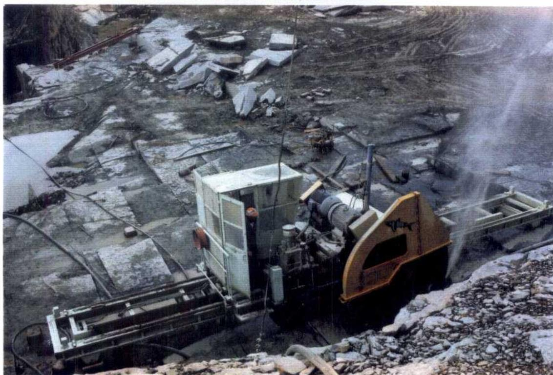
**Fotografía N° 4.- Arranque del rachón mediante cortadora de disco fija**
