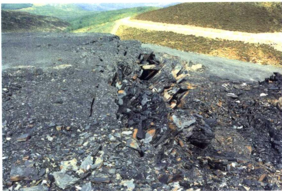
**Fotografía N° 21.- Rotura por vuelco (toppling) en la Cantera Corporales**
