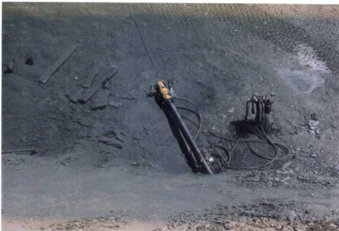
**Fotografía N° 5.- Preparación del barreno horizontal para el arranque con hilo diamantado**
