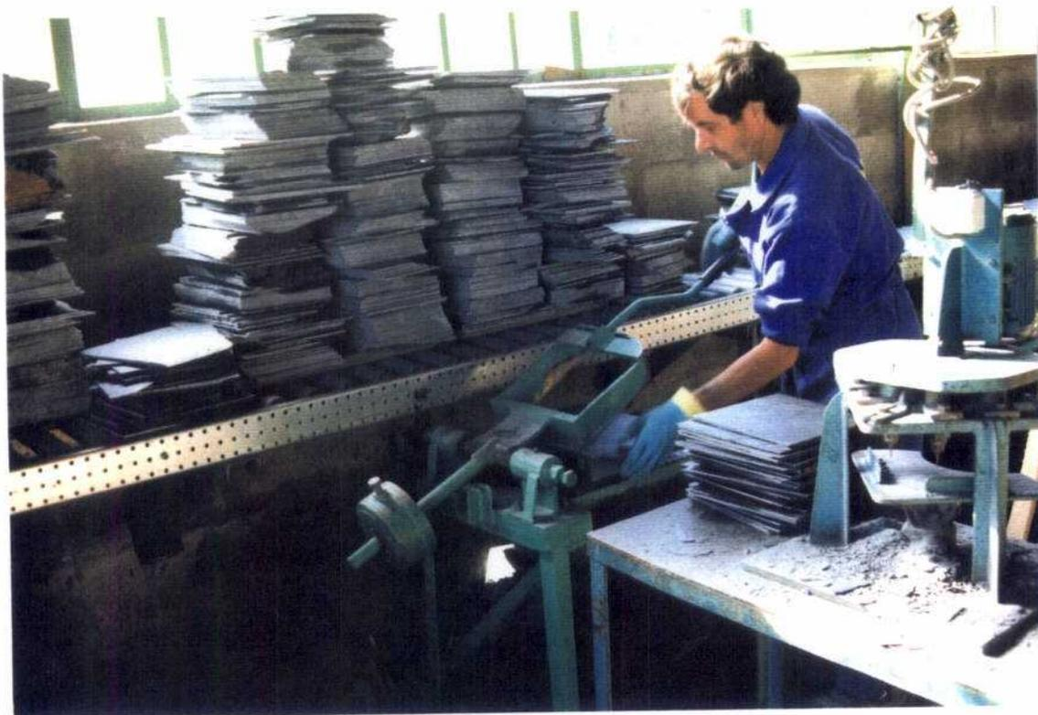
**Fotografía N° 13.- Cortado de las placas mediante troquelado**
