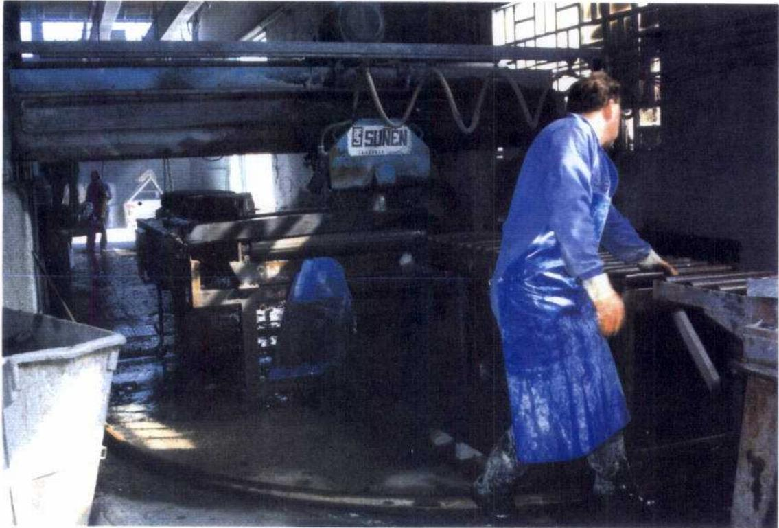
**Fotografía N° 11.- Preparación del rachón en la sierra para su labrado (serrado)**
