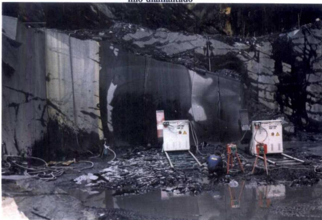
**Fotografía N° 6.- Maquinaria empleada para el arranque con hilo diamantado**
