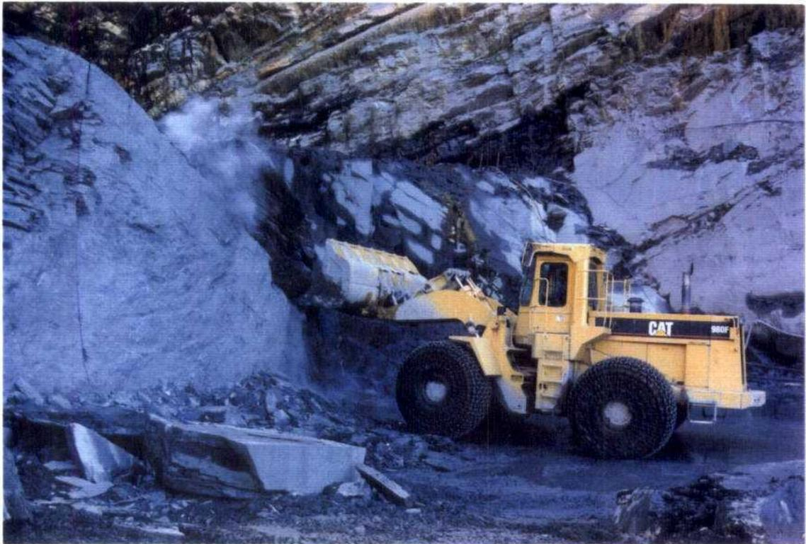
**Fotografía N° 7.- Arranque del ración directamente con pala, aprovechando la pizarrosidad**
