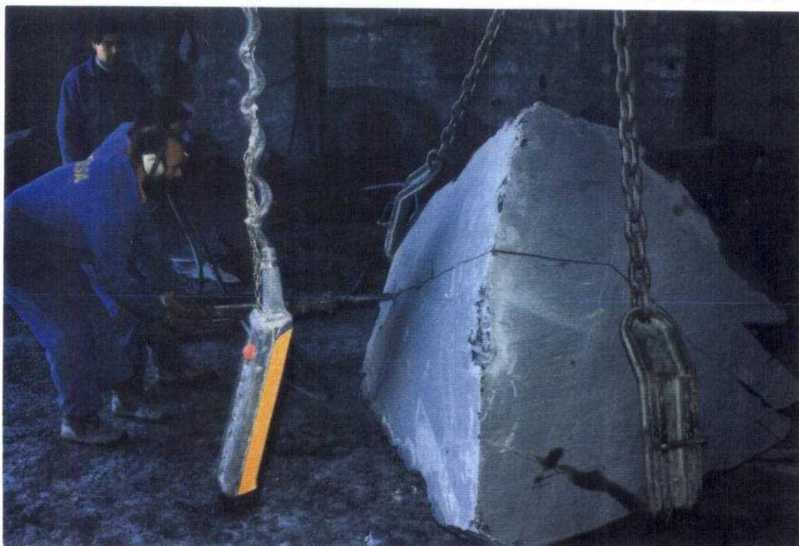
**Fotografía N° 10.- Adecuación del ración de pizarra al tamaño del diámetro del disco de la sierra, antes de su carga con el puente-grúa (Exfoliación primaria)**
